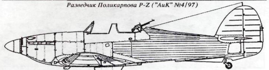
Двухместный разведчик-корректировщик, выполненный в Советском Союзе на базе "Харрикейна" ("К-Д" №1/97)
